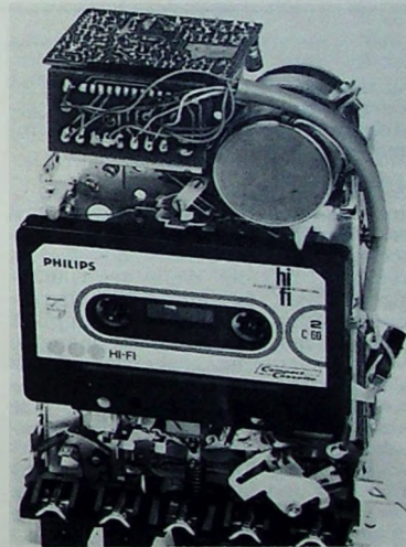
Bild 4 (unten). Fühler für Aufnahmesperre (links) und Bandsortenumschaltung
